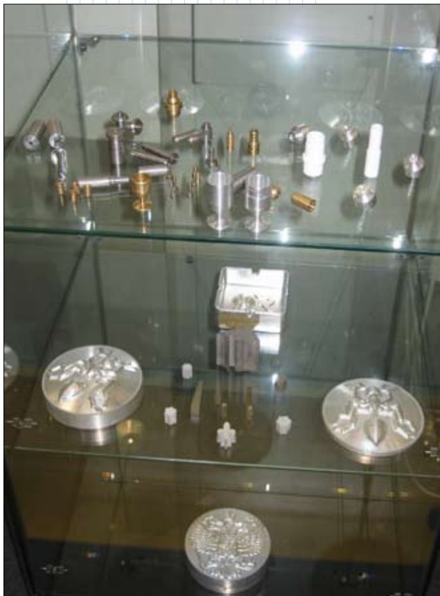
Образцы деталей, изготовленные специалистами компании “Perytone industrial” по траекториям, созданным средствами Mastercam
