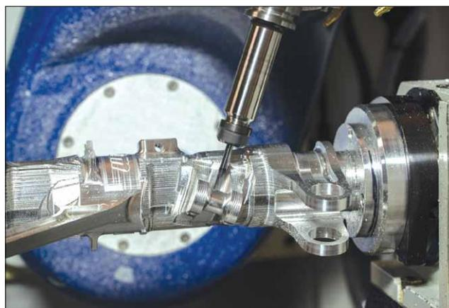
Процесс изготовления сложной детали для шасси самолета сильно выигрывает от применения стратегий многоосевой обработки Mastercam
