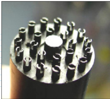
Детали для медицинских инструментов (medical part) настолько малы, что на одноцентовой монете их можно уместить с полсотни. ИТ-среда компании MPPM обеспечивает комплексное решение, сочетающее расчет траектории инструмента (toolpath) и закрепления заготовок (workholding), что позволяет изготавливать одновременно по 20 таких деталей (фото публикуется с разрешения компании CNC Software)
