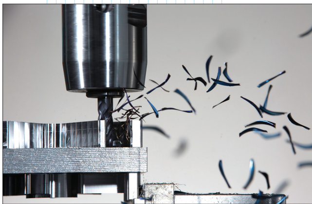
Стратегии Динамической обработки ( Dynamic Motion ) обеспечивают равномерный съём стружки оптимальной толщины
