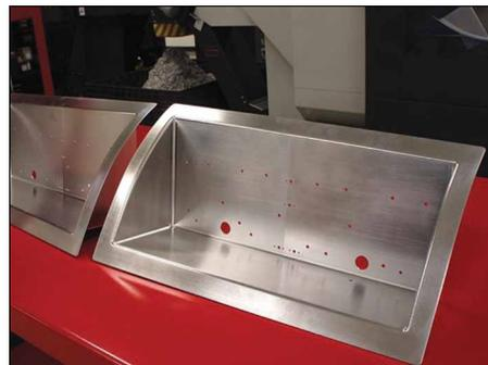
*Удаление большого количества материала характерно для обработки авиакосмических и автомобильных деталей. Каждая алюминиевая заготовка, из которой изготовлен корпус осветителя шасси, весила свыше 90 кг. Более половины этого материала было удалено методом черновой 3-осевой обработки*
