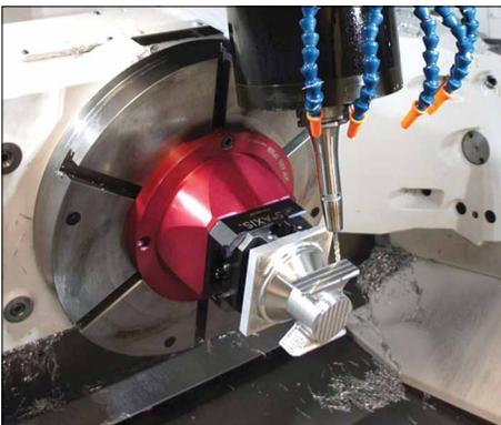
*Существенными пунктами “предполетной подготовки” является наличие большого 5-осевого станка, приспособлений типа “ласточкин хвост” для фиксации детали, специальных термопатронов для зажима инструмента, высокопроизводительных режущих инструментов и формируемых современной CAM-системой Mastercam траекторий*
