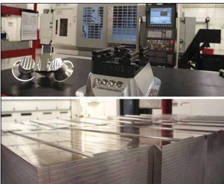
*Для 5-осевых операций используется крепежное приспособление компании 5th Axis, в котором детали удерживаются с помощью двухмиллиметровых выступов типа “ласточкин хвост”, которые на заготовках делают заранее на 3-осевом вертикальном станке Okuma GENOS M560-V (виден на заднем плане)*
