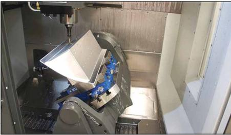
*Большая часть чистовой обработки корпуса осветителя шасси выполнялась на новейшем 5-осевом обрабатывающем центре. Но на данной фотографии запечатлен третий установ детали: на более старом 5-осевом станке подчищаются те зоны, которые нельзя было обработать за второй установ. Хотя эту операцию можно было бы выполнить и на 3-осевом оборудовании, на 5-осевом станке проще наклонить деталь для съема оставшегося металла*
