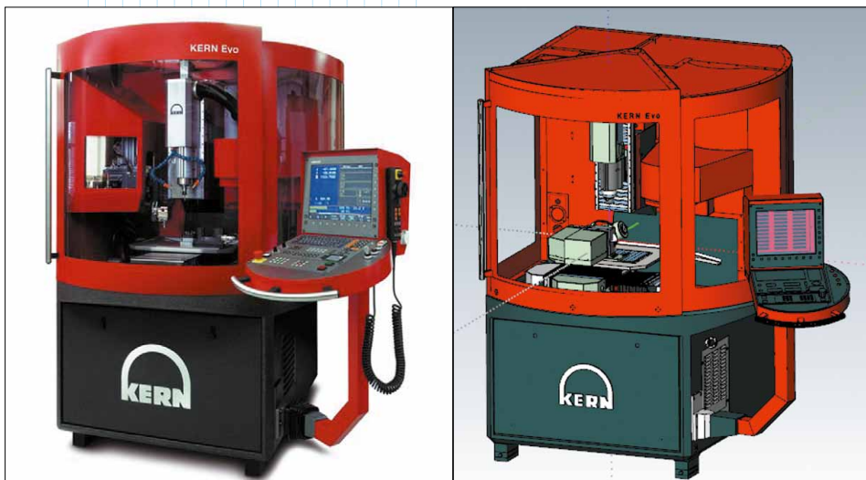
Слева показан некий очень точный и быстрый станок, справа – его симуляционная модель. Риторический вопрос: на чём лучше производить отладку и проверку УП без боязни “угробить” оборудование? Всегда пользуйтесь компьютерными средствами симуляции, даже для относительно простых деталей. Не забудьте, что таким образом можно проверить и правильность расположения детали в пространстве станка
