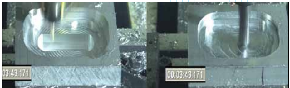
Рис. 2. Два процесса черновой обработки матрицы со сравнением по времени обработки
