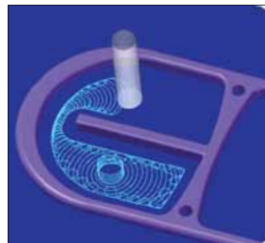
Рис. 6. Траектория обработки, использующая новый метод “Зигзаг”
