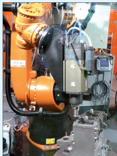
Рис. 11. Робот KUKA фрезерует блок цилиндров двигателя
