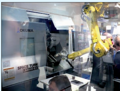
Рис. 10. Робот FANUC устанавливает заготовки на токарном станке OKUMA и снимает готовые детали
