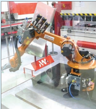
Рис. 9. Робот ABB изготавливает металлические ящики с помощью гибочной машины
