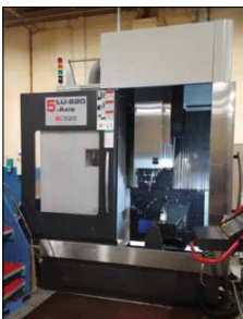
После покупки 5-осевого фрезерного станка MC Machinery Systems Model LU-620 компания McAfee Tool & Dieполнила список клиентов предприятия из авиакосмической отрасли, так как обрела способность обрабатывать детали сложной специфической формы, что было не под силу с имевшимся 3- и 4-осевым оборудованием
