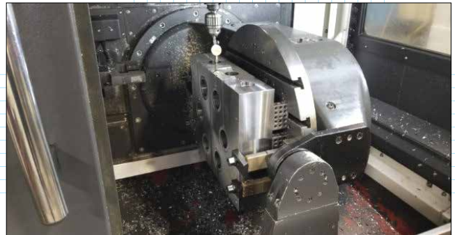
Новый 5-осевой фрезерный станок, позволяющий компании McAfee Tool & Die обрабатывать детали сложной формы за один установ, увеличил производительность цеха ЧПУ-обработки примерно на 25÷30%. В ближайшем будущем планируется купить еще один 5-осевой станок
