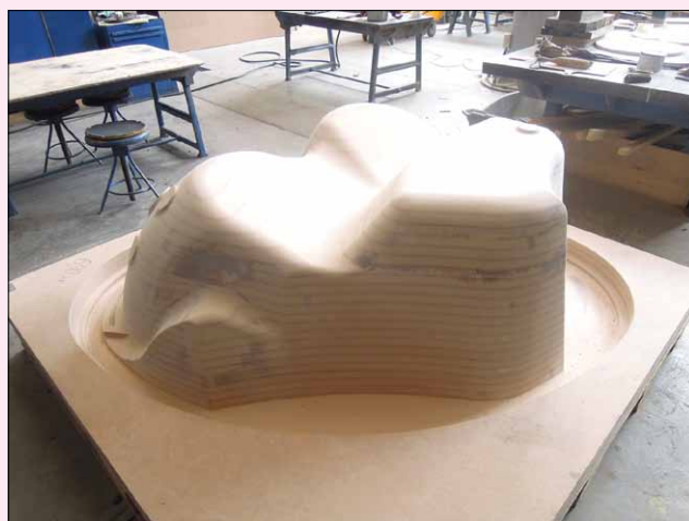
Не менее внушительная обработанная роботом мастер-модель для получения формы внутренней поверхности двухместной ванны-джакузи
