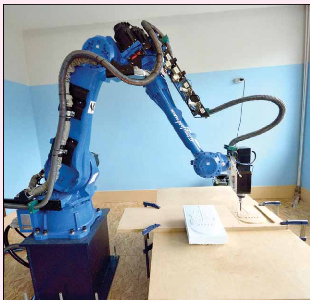
Робот MOTOMAN, оснащенный шпинделем, может стать эффективным и универсальным решением для механической обработки мягких материалов и деревообработки – фрезерования, сверления и гравировки
