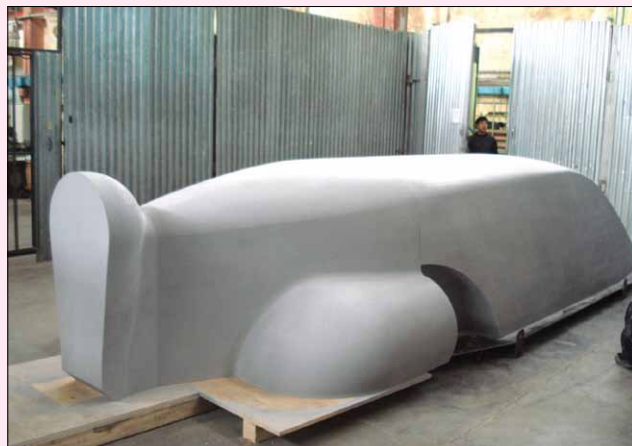
Оснастка под стеклопластик – мастер-модель надстроечной части судна на воздушной подушке
