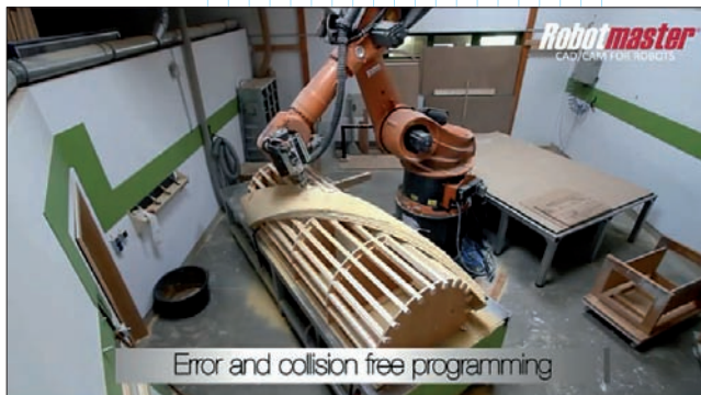
Фрезерование косоура винтовой лестницы по УП, полученной в системе Robotmaster (Jabez Technologies)
