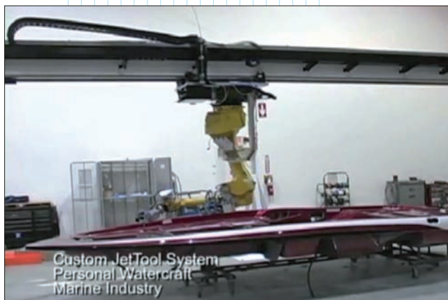
Вырезы на палубе катера; робот перемещается по линейной направляющей “головой вниз” (KMT Robotic Solutions)
