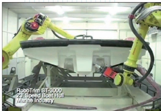
Одновременная обрезка частей корпуса и обработка вставки повышения плавучести для быстросходного катера ( KMT Robotic Solutions )
