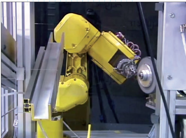
Добработка крепежной детали на наждачном круге; робот оснащен датчиком давления (Weldon Solutions)
