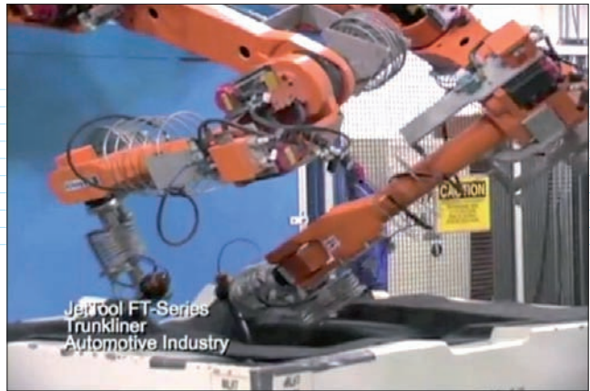
Резка водяной струей; ячейка оборудована сразу двумя манипуляторами (KMT Robotic Solutions)
